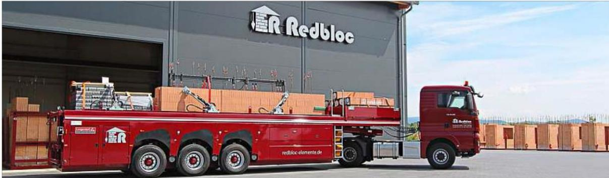
**Die massiven Ziegelwände** entstehen im Werk wetterunabhängig und im Trockenbau. Mit dem Innenlader rollen die Wände, die den Rohbau für ein Massivhaus in wenigen Tagen ermöglichen, auf die Baustellen. Durch den Anbau entstand Platz für die neue, noch leistungsstärkere Fertigungsanlage und zusätzliche Lagerfläche für die Ziegel. In wenigen Wochen soll der Umbau in der Kurt-Kerschl-Straße abgeschlossen sein. – Fotos: Ebner
