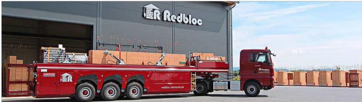
Die massiven Ziegelwände entstehen im Werk wetterunabhängig und im Trockenen. Mit dem Innenlader rollen die Wände, die den Rohbau für ein Massivhaus in wenigen Tagen ermöglichen, auf die Baustellen. Durch den Anbau entstand Platz für die neue, noch leistungsstärkere Fertigungsanlage und zusätzliche Lagerfläche für die Ziegel. In wenigen Wochen soll der Umbau in der Kurt-Kerschl-Straße abgeschlossen sein. – Fotos: Ebner
