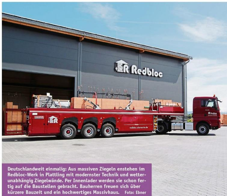
Deutschlandweit einmalig: Aus massiven Ziegeln entstehen im Redbloc-Werk in Plattling mit modernster Technik und wetterunabhängig Ziegelwände. Per Innenlader werden sie schon fertig auf die Baustellen gebracht. Bauherren freuen sich über kürzere Bauzeit und ein hochwertiges Massivhaus. Foto: Ebner
